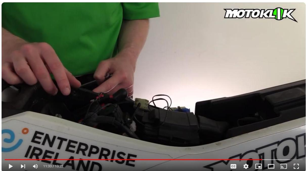
Stecken Sie das Motoklik CCU-Stromversorgungskabel wieder in den OBD-Stecker.
