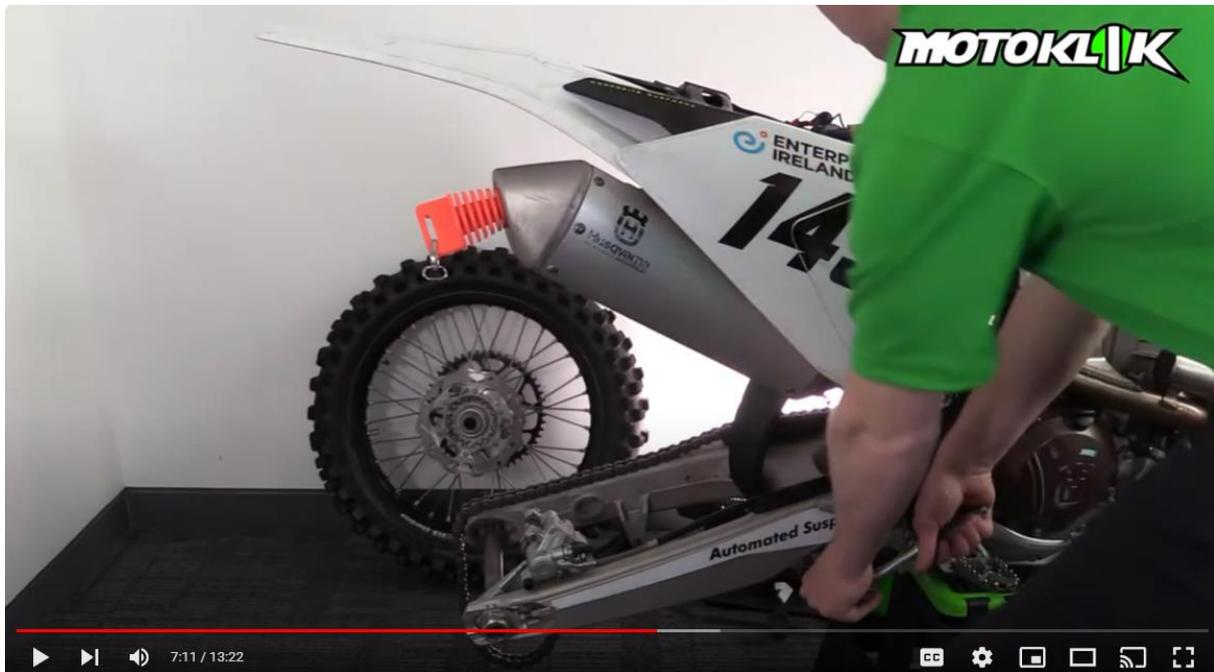
Sichern Sie die Schwinge mit einem Gurt in der vollständig komprimierten Position.
